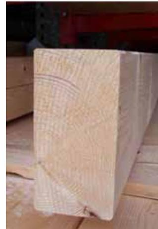
Trockenes KVH verändert in Abhängigkeit von der Gleichgewichtsfeuchte sein Rißbild und seine Geometrie nicht mehr oder nur noch in sehr geringem Umfang. Dadurch ist die Maßhaltigkeit der Bauteile im Einbauzustand gewährleistet. Nachteilige Veränderungen, wie übermäßige Rißbildung, starkes Verdrehen usw. sind ausgeschlossen.
