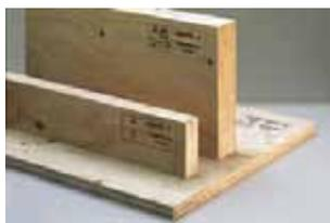
KERTO Furnierschichtholz ist aus ca. 3 mm starken Fichtenschäl furnieren verleimt. Für plattenförmige Anwendungen kommt KERTO Q (Furnierlagen in Längs- und Querrichtung) und für stabförmige Anwendungen KERTO S (alle Furnierlagen in Plattenlängsrichtung) zum Einsatz.
